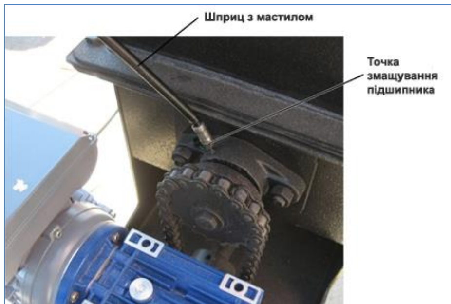
Малюнок 16. Змащування підшипників шнекової подачі.
