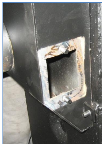
Малюнок 18. Отвір для чищення адаптера диму
