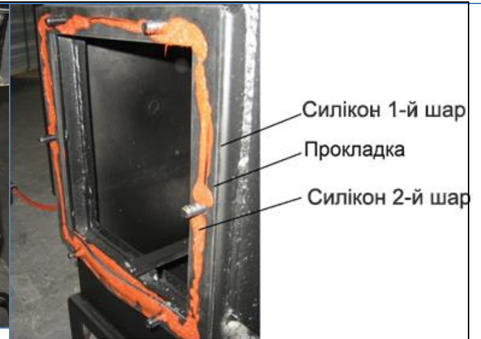
Малюнок 30. Встановлення прокладки на силікон і нанесення другого шару.
