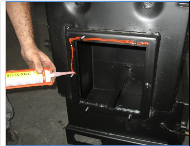
Малюнок 29. Нанесення жаростійкого силікону перед встановленням прокладки.
