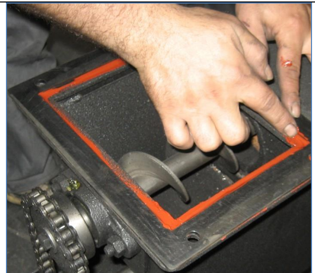
Малюнок 32. Встановлення прокладки між бункером і корпусом шнекової подачі.
